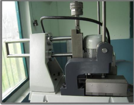
Sertleştirilmiş miller üzerinde hareket eden kaynak temizleme kafası Welding burr remover head riding on hardened spindles Перемещение зачистной головки по закаленным шпинделям
